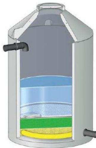
In particolare, le prove hanno testato il sistema per quanto concerne l'efficacia di rimozione di rame, zinco e piombo e piccole concentrazioni di liquidi leggeri.
