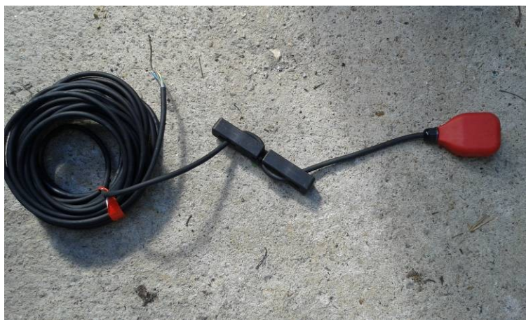
Posizionamento peso per galleggiante
