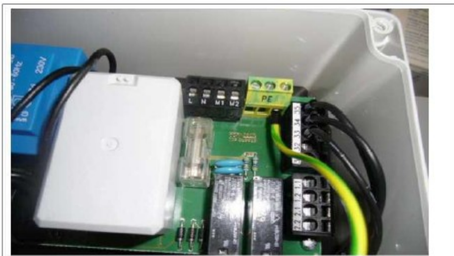
Antrieb der Absperrrklappe: (3.3)=öffnen; (3.4)=Schließen; (3.4)=N Comandi elettrosaracinesca nel deviatore: 3.3 APRE 3.4. CHIUDE
